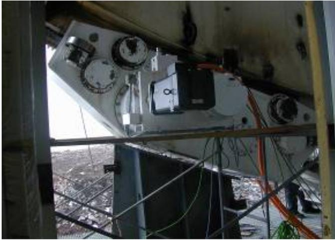
Las cremalleras y motores de elevación.
