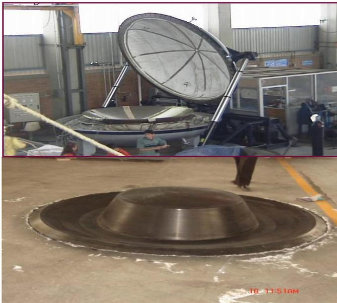
La autoclave en una nave industrial del CIATEQ, con el molde del reflector secundario en su interior. A la derecha, la membrana de soporte del espejo ya curada.
